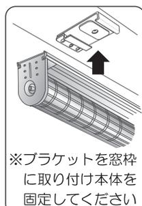
※ブラケットを窓枠に取り付け本体を固定してください
